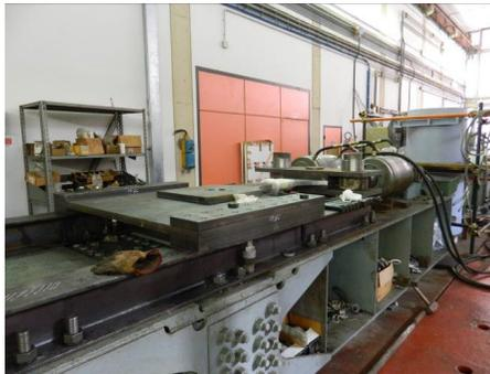
Azionamento di banchi per prove di fatica con unità oleoidrauliche servo-controllate (in collaborazione con MASTEL)
